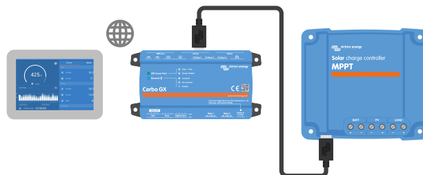
Conexión de la aplicación VictronConnect por LAN o Internet (VRM Portal) con un dispositivo GX (por ejemplo, un Cerbo GX)
